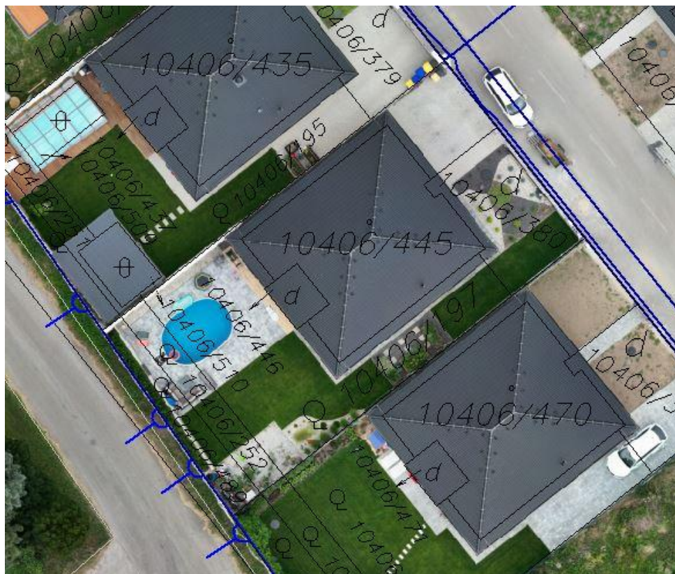
Obr. 22: Možnosť využitia ortofotomozaiky z UAV pri revízii katastrálneho operátu.
