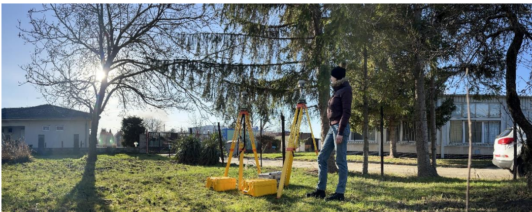
Obr. 7: Testovacie meranie 31 vs. 32 v sťažených podmienkach, k.ú. Trnávka
