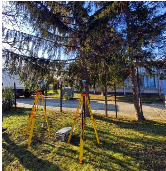
Obr. 18: Testovacie meranie 32 vs. NRS v sťažených podmienkach, k.ú. Trnávka
