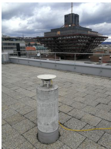
Obr. 5 Fyzická monitorovacia stanica SUT2 (vľavo) a ukážka monitoringu stanice SUT2 v riadiacom softvéri SKPOS (vpravo).
