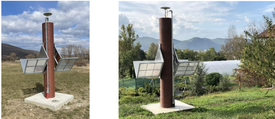
Obr. 3 Ukážka stabilizácii referenčných staníc DVCN (vľavo) a ZVOL (vpravo) s InSAR odrážačom.
