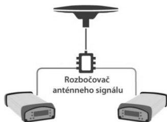
Obr. 4 Schéma pripojenia dvoch prijímačov na jednu anténu.
