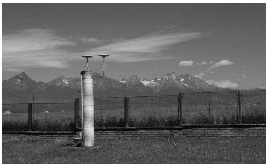
Obr. 6 Referenčná stanica GANP s dvoma anténami.
