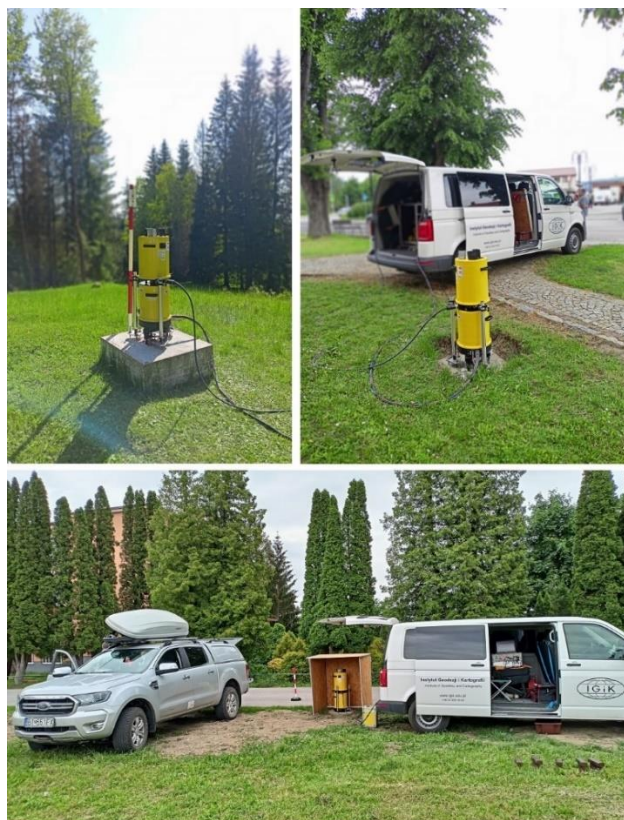
Ukážka merania absolútnym poľným gravimetrom na bodoch ŠGS
