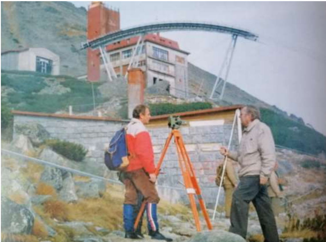
Obr. 35 Výškové pripájanie geodynamického bodu Skalnaté Pleso pracovníkmi GKÚ v roku 1993
