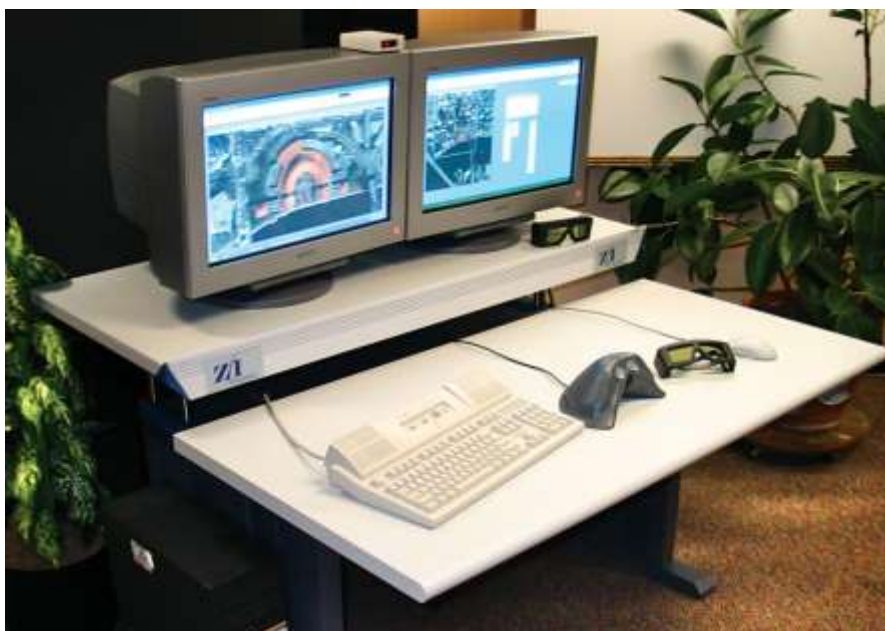
Obr. 53 Digitálna fotogrametrická stanica Z/I ImageStation SSK z roku 2004 [74]
