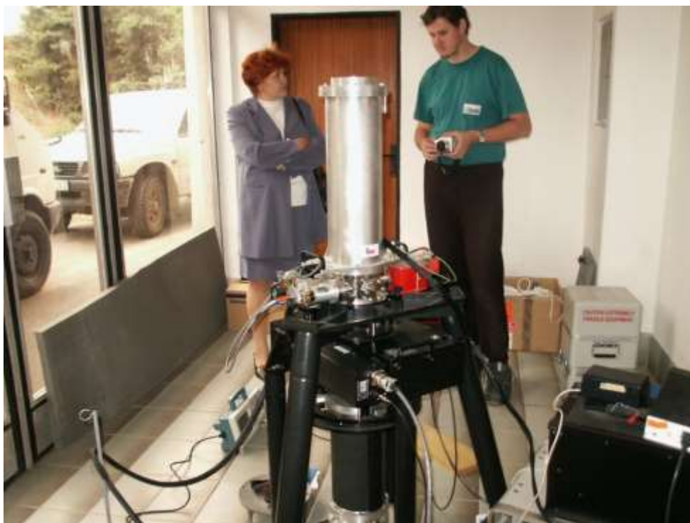
Obr. 65 Absolútne meranie gravimetrom FG5-215 na bode Vinosady v roku 2004
