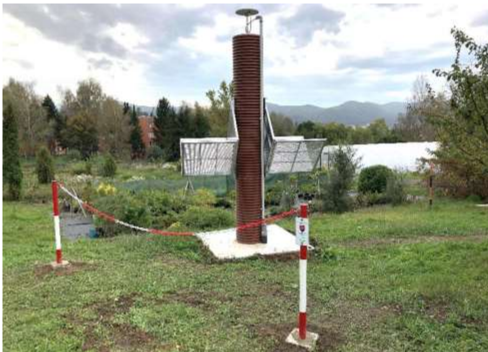
Obr. 94 SKPOS stanica Zvolen – Borová hora s kútovým odrážačom pre metódu InSAR
