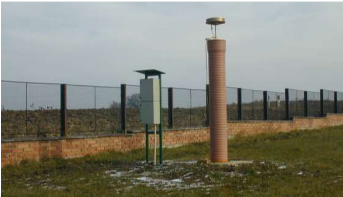
Obr. 64 Permanentná stanica GNSS v Gánovciach po vybudovaní v roku 2002
